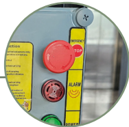
Sécurité arrêt coup de poing
