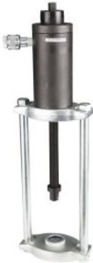
**Artikelbezeichnung** HYDRAULISCHE EXTRAKTIONSPRESSE MIT STÜTZSCHALEN
