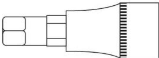
**Artikelbezeichnung** HEXAGONAL-BUCHSENSCHLÜSSEL 22mm L.55mm 1/2"
