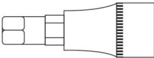
**Artikelbezeichnung** HEXAGONAL-BUCHSENSCHLÜSSEL 19mm L.55mm 1/2"
