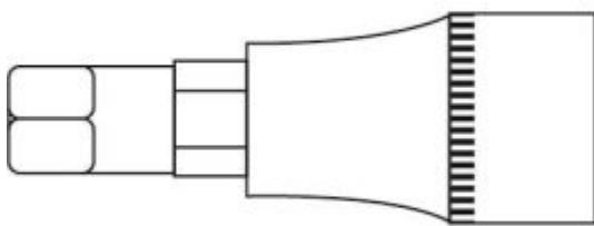
**Artikelbezeichnung** HEXAGONAL-SCHRAUBENDOULE 6mm L.55mm 1/2"
