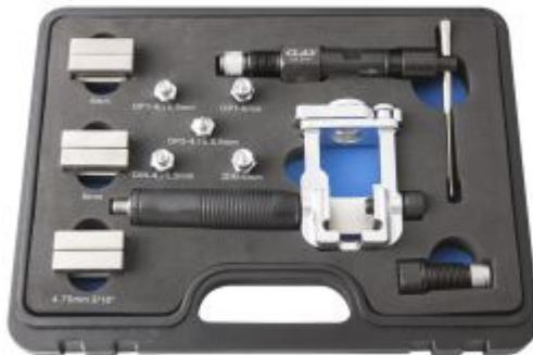
**Artikelbezeichnung** KOFFER FÜR DIE REPARATUR VON BREMSLEITUNGEN DIN/SAE
