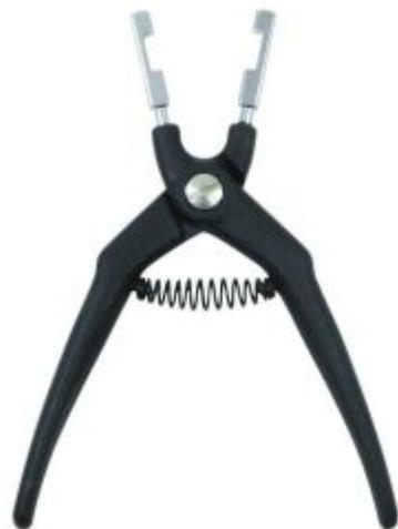
**Artikelbezeichnung** ZANGE FÜR KRAFTSTOFFANSCHLÜSSE BENZIN UND DIESEL
