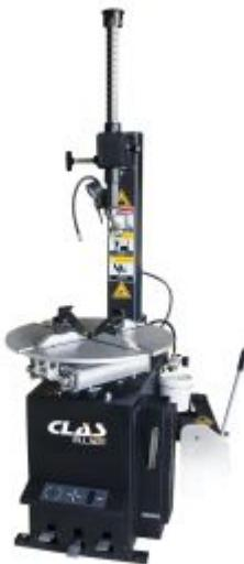
**Artikelbezeichnung** HALBAUTOMATISCHE REIFENMONTIERMASCHINE 10"-21" 1
