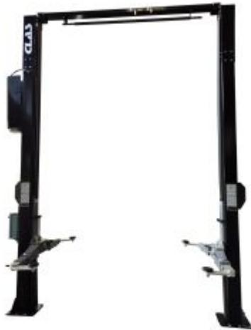
**Artikelbezeichnung** 2-SÄULEN-HEBEBRÜCKE HOCHPASS 4.60m 400V 4T 4 STRAHLEN 1.80m
