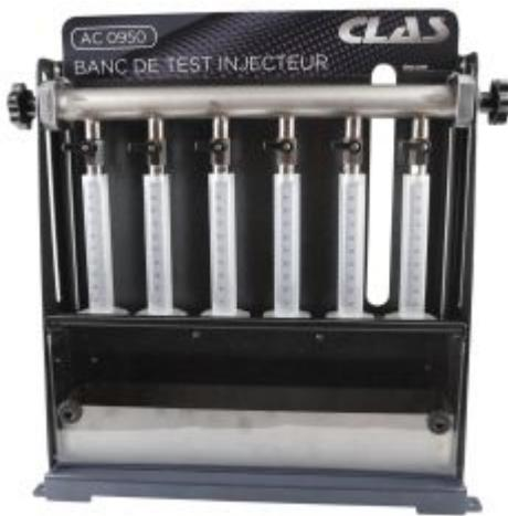
**Artikelbezeichnung** PRÜFSTAND FÜR INDIREKTE BENZINEINSPRITZUNG
